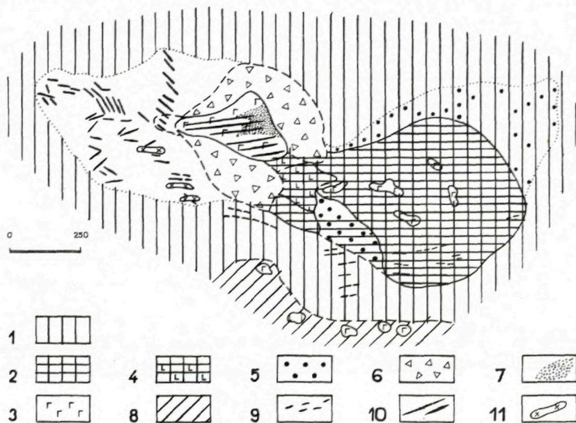
Obr. 3 Geologická mapa „gabrovej hôrky“ v chantajširskom ofiolitovom komplexe (j. od mesta Altaj) 1—apodunitové serpentinity; 2—pyroxenity; 3—gabroidy; 4—gabroidizované pyroxenity; 5—delúvium pyroxenitov; 6—delúvium a elúvium gabier; 7—zóna prekremenenia gabra; 8—serpentinitové bridlice; 9—dajky klinopyroxenitov; 10—dajky diabázových porfyrítov; 11—dajky aplítov.
